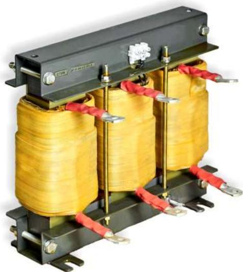
Компенсационный реактор (дрессель) предназначен для защиты трёхфазного конденсатора компенсации реактивной мощности (КРМ) от высших гармоник тока и представляет собой три конструктивно объединённые алюминиевые или медные обмотки.
