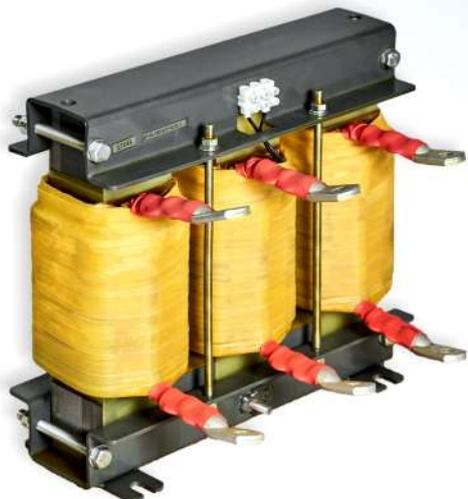
Сглаживающие реакторы - это реакторы, предназначенные для включения последовательно в цепь постоянного тока с целью снижения пульсаций тока. Сглаживающие электрические реакторы (дрессели) применяются в выходных контурах выпрямителей, где обеспечивают значительное ограничение пульсаций выпрямленного тока. Часто к сглаживающим реакторам подключают конденсаторы, образуя LC-фильтры.
