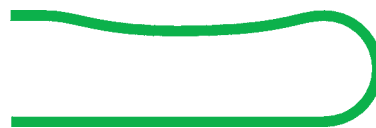
Самонесущая цепь с допустимым провисом
