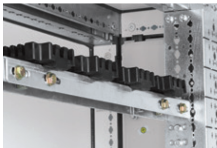
Закрепите суппорты на стойках четырьмя клипсами и винтами (момент затяжки 10 Н·м)
