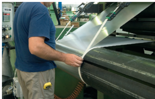
Изготовление обмотки низкого напряжения
