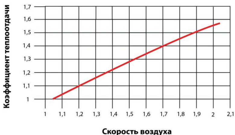
Рис. 4. График зависимости коэффициента теплоотдачи от скорости воздуха
