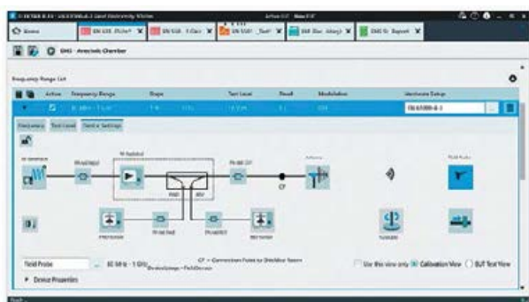
Шаблон автоматического проведения испытаний на ЭМВ с возможностью просмотра и изменения аппаратных настроек и конфигураций в одном окне
