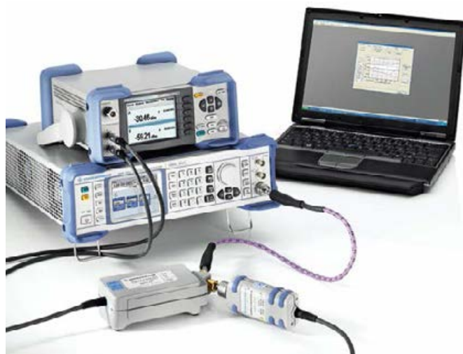
Измерительная установка для калибровки преобразователя мощности NRP-Z55
