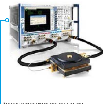
Измерение параметров пленок на основе резонатора
