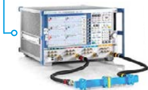
Измерение параметров материалов в волноводе
