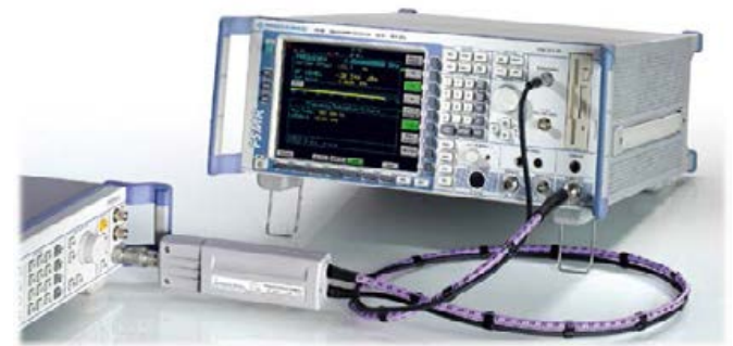
Входной каскад ВЧ-тракта с термопарным преобразователем
