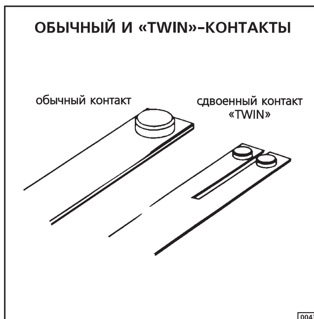
Мощные контакты всегда одиночные, а для сигнальных цепей лучше подходят контакты типа TWIN Рисунок 45
