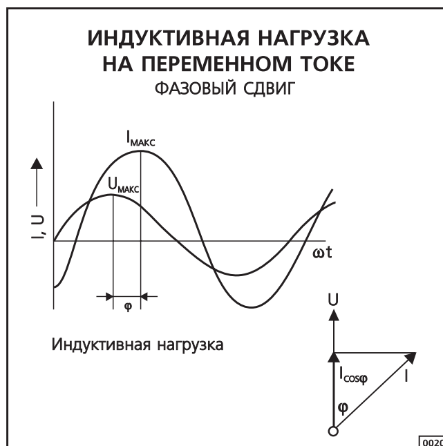
Сдвиг по фазе между I и U в индуктивной нагрузке: контакты следует размыкать в «нуле» тока Рисунок 21
