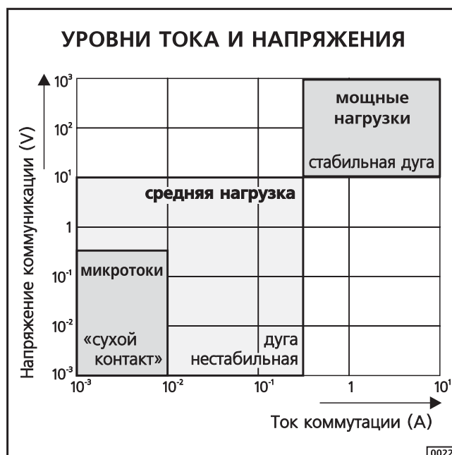
Контакты реле оптимизированы для работы в одном из трех указанных диапазонов тока и напряжения Рисунок 23
