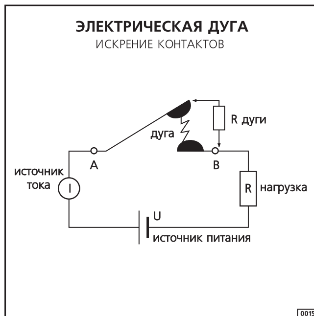
При замыкании и размыкании контактов в контактном промежутке образуется электрическая дуга Рисунок 16
