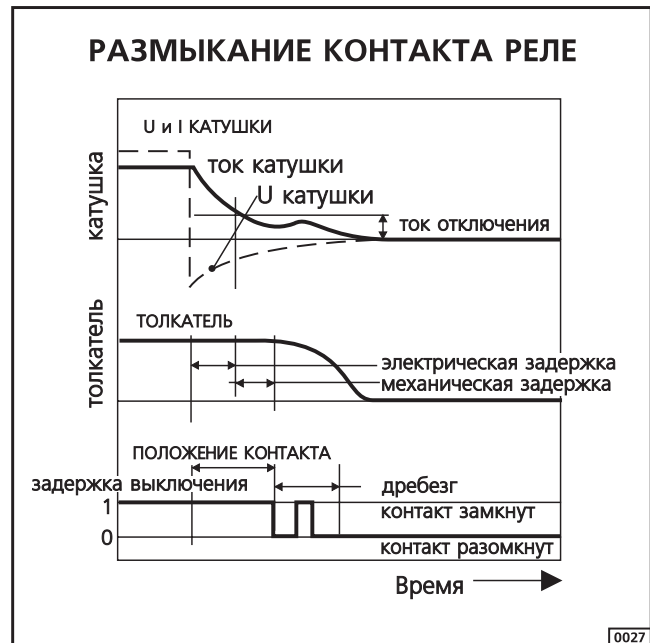
При размыкании контакта снова проявляются задержка и дребезг Рисунок 28
