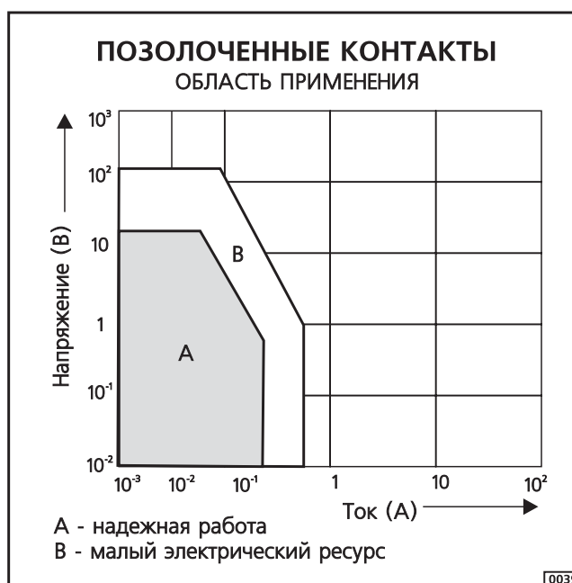
Контакты с золочением подходят только для коммутации сигнальных цепей Рисунок 41
