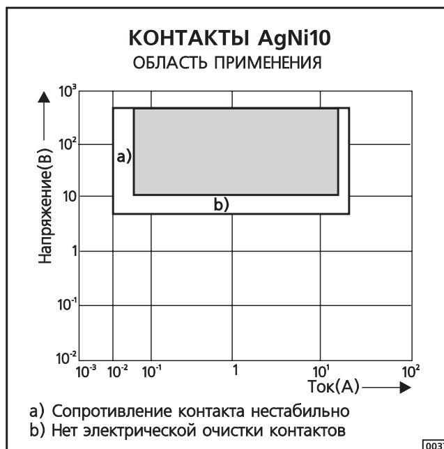
Сплав серебро-никель: экологически чистая замена для сплава AgCdO Рисунок 39
