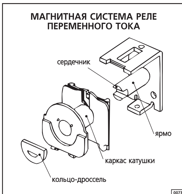
Короткозамкнутый дроссель необходим для устранения дребезга контактов при питании катушки переменным током Рисунок 75
