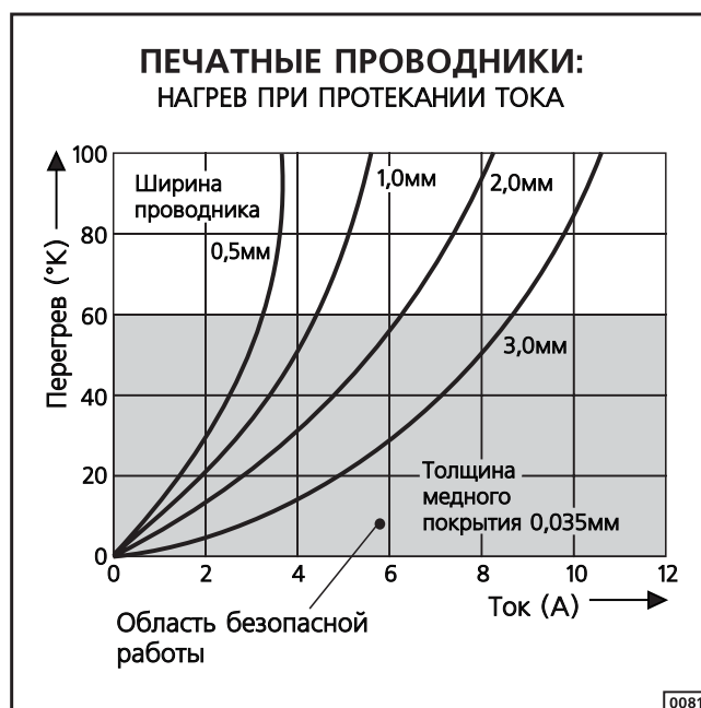
При протекании тока в проводнике выделяется тепло, что следует учитывать при разработке печатных плат Рисунок 85
