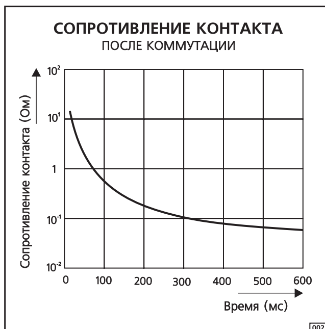
После включения сопротивление контакта начинает уменьшаться: так работает электрическая очистка Рисунок 26
