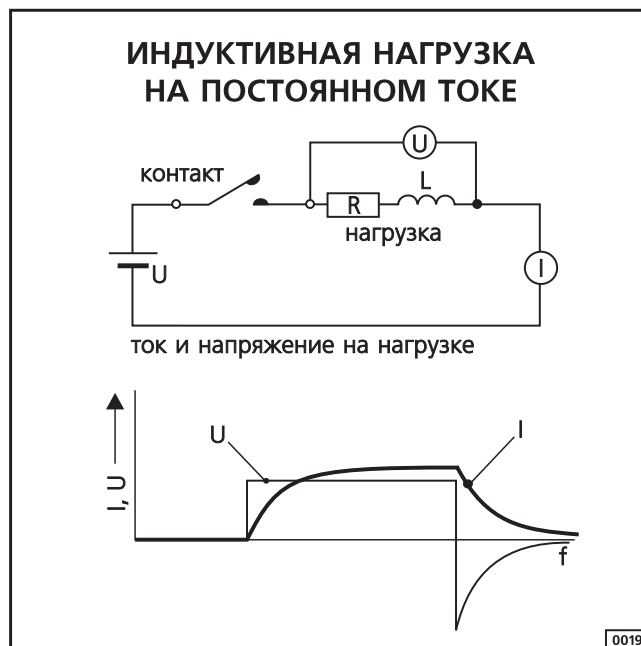
Выброс напряжения при отключении индуктивной нагрузки: большая проблема для контактов реле Рисунок 20
