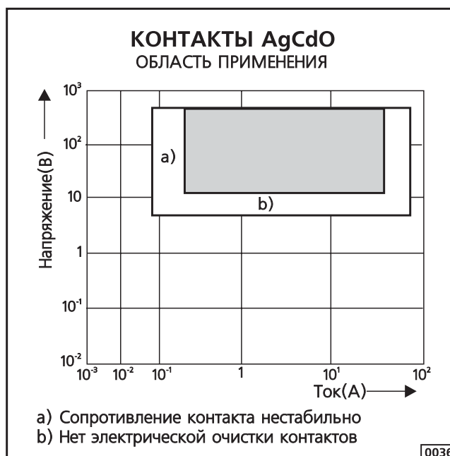
Сплав AgCdO хорошо подходит для коммутации больших токов и индуктивных нагрузок Рисунок 38
