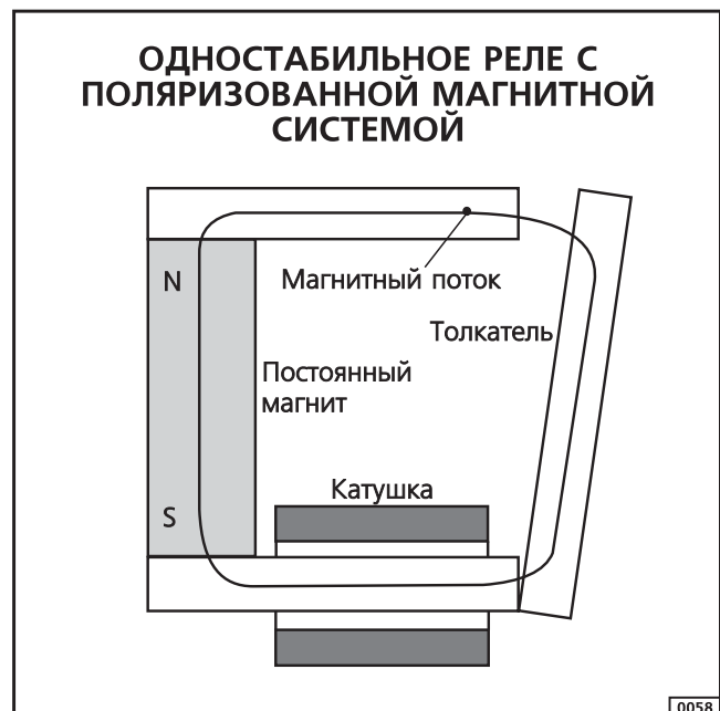
Добавление к магнитной системе постоянного магнита повышает чувствительность реле Рисунок 60
