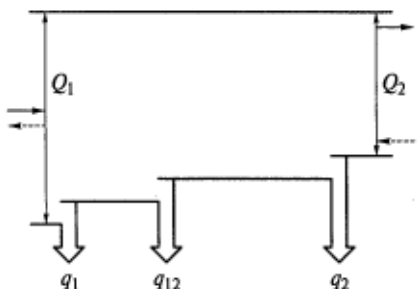
Рис. 3.18. Диаграмма преобразования реактивной мощности в трансформаторе
