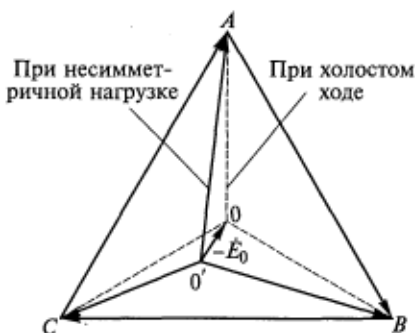
Рис. 4.6. Искажение звезды фазных напряжений при несимметричной нагрузке трансформатора в схеме соединения Y/Y_0
