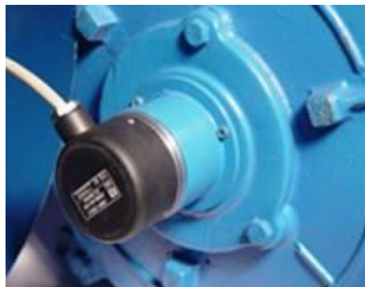
Рис. 3.1. Энкодер на валу двигателя
