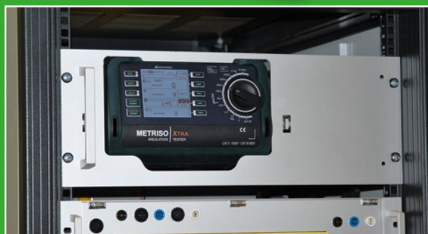
серия MetrisoP монтаж в стойке 19"
