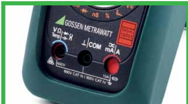
Разъемы с автоблокировкой предотвращают неправильное подключение измерительных кабелей и выбор неверно измеренного количества.
