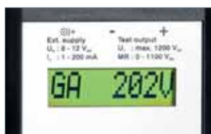
Отображение замеренного пробивного напряжения.
