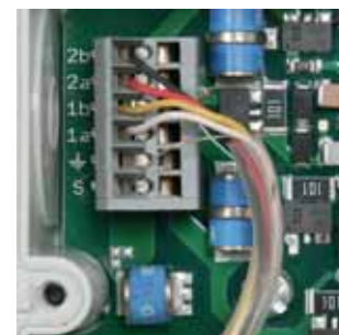
Возможность прямого или непрямого заземления экрана (DBX U4/U2 KT BD S 0-180).
