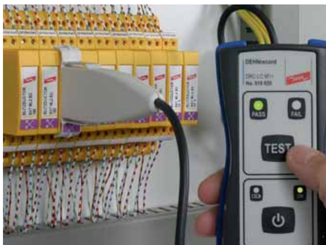
Проверка модуля УЗИП с RFID технологией (LifeCheck)
