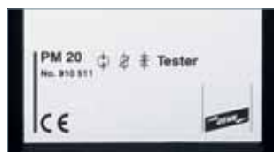
Могут тестироваться УЗИП, основанные на использовании варисторной технологии, технологии диодов Зенера или газовых разрядников.
