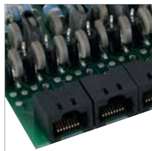
С разъемами RJ45 для дооснащения существующего оборудования.
