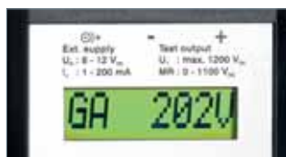
Отображение измеренного пробивного напряжения.
