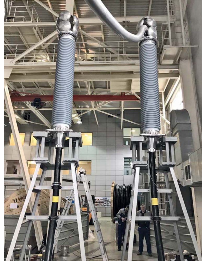
Испытания концевой муфты «Изолятор-АКС» Testing of Izolyator-AKS end sleeve
