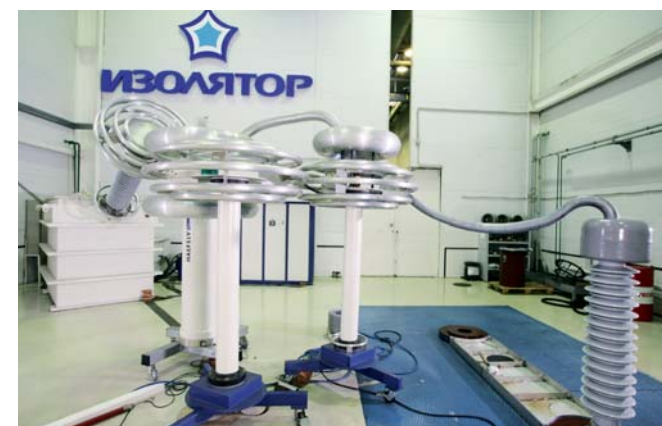
Испытания ввода 126 кВ Testing of a 126 kV bushing
