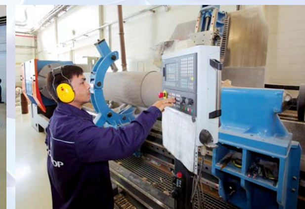
Задание программы токарной обработки Setting of a turning program on a lathe
