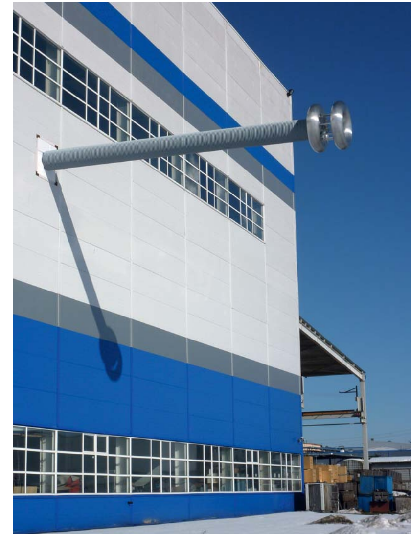
Испытания ввода 820 кВ постоянного тока на заводе «Изолятор» Testing of 820 kV DC bushing at Izolyator plant
