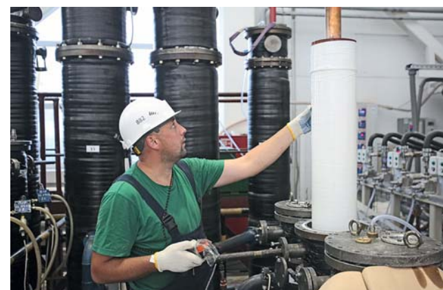
Загрузка изоляции в пропиточную камеру Loading of insulation into the impregnation chamber
