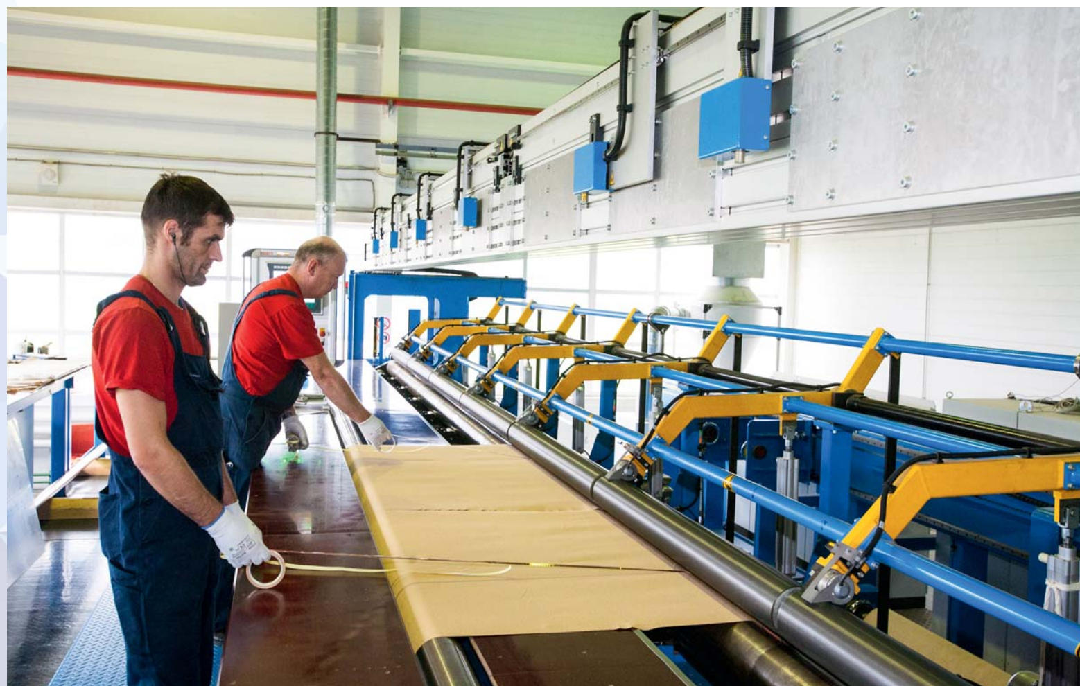
Намотка основной изоляции Winding of the main insulation
