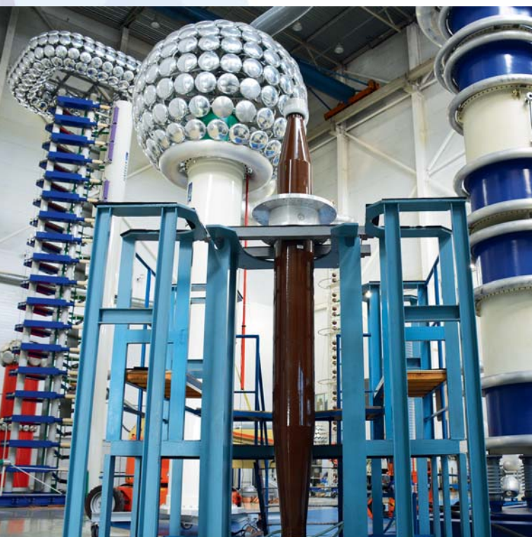
Испытания ввода 550 кВ «масло — элегаз» для КРУЭ Testing of 550 kV «oil — SF 6 » bushing for GIS
