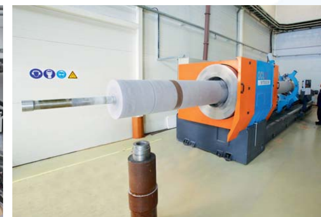
Токарная обработка изоляции 363 кВ Turning of 363 kV insulation
