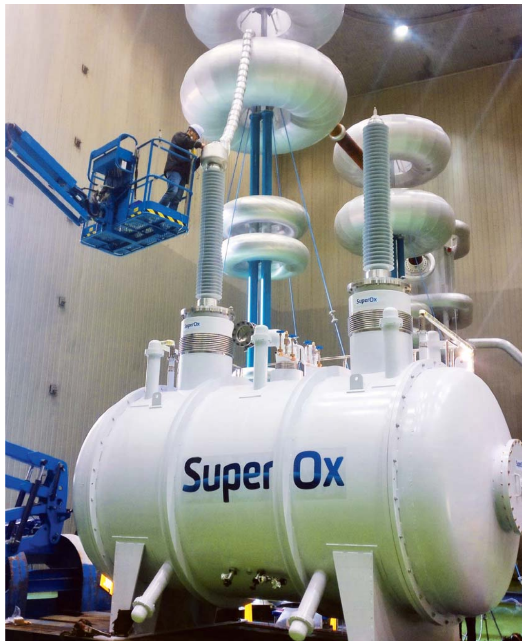
Испытания высокотемпературного сверхпроводящего токоограничивающего устройства «СуперОкс» с вводами «Изолятор» в Корейском электротехническом исследовательском институте Testing of SuperOx superconducting fault current limiter with Izolyator bushings at the Korean Electrotechnology Research Institute
