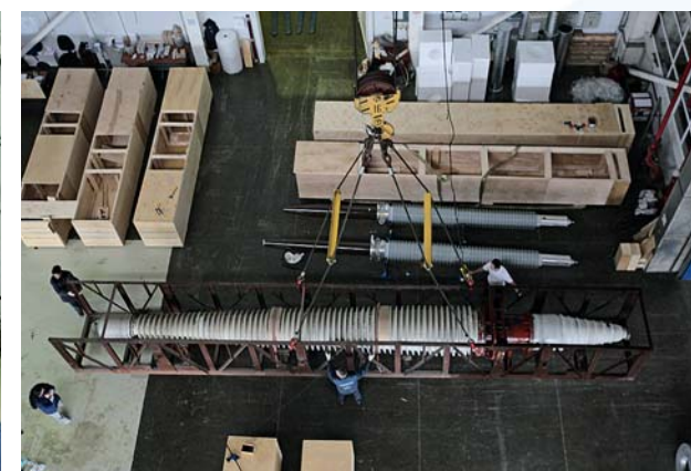
Упаковка ввода 1200 кВ Packing of a 1200 kV bushing
