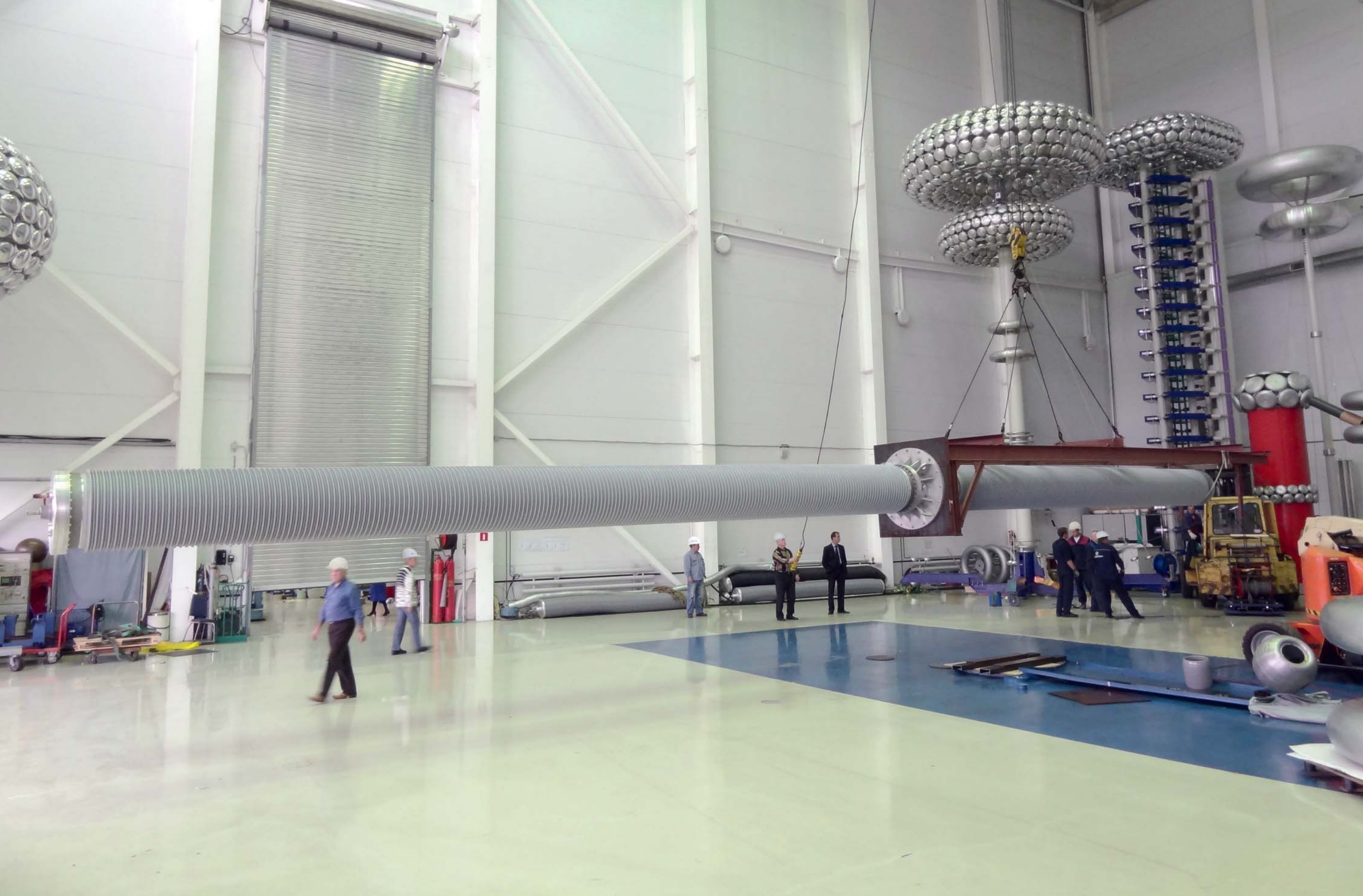
Линейный ввод 820 кВ постоянного тока в испытательном центре 820 kV DC wall bushing at the test center
