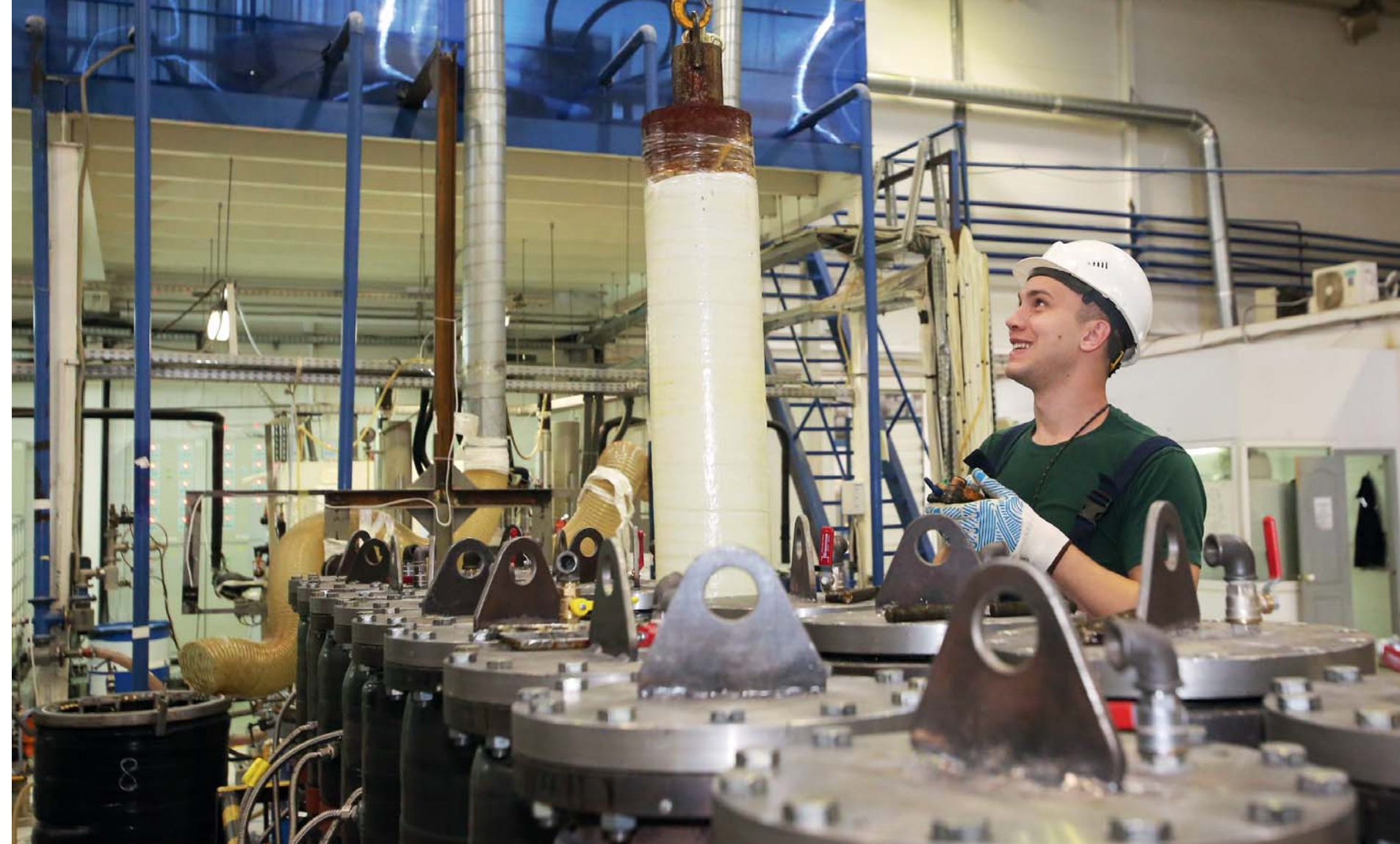
Выгрузка изоляции из полимеризационной печи Unloading of the insulation from the polymerization chamber
