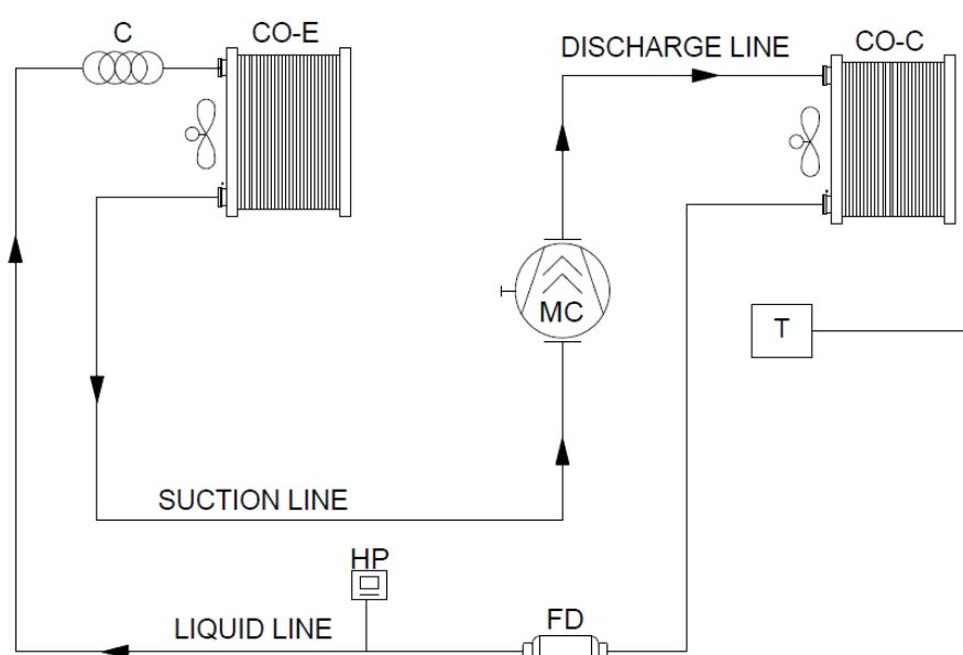
Il condizionatore è progettato per il raffreddamento degli armadi elettrici. Può essere utilizzato con montaggio a tetto esternamente al quadro. Il suo utilizzo consente di raffreddare e deumidificare l'aria all'interno dell'armadio ed evitare il malfunzionamento dei particolari elettrici ed elettronici ivi installati. Il condizionatore è dotato di un termostato ad intervento regolabile. Il circuito frigorifero inizia a funzionare solo al raggiungimento della temperatura impostata.
