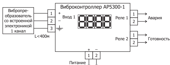
Электрическая схема подключения AP5300-1
