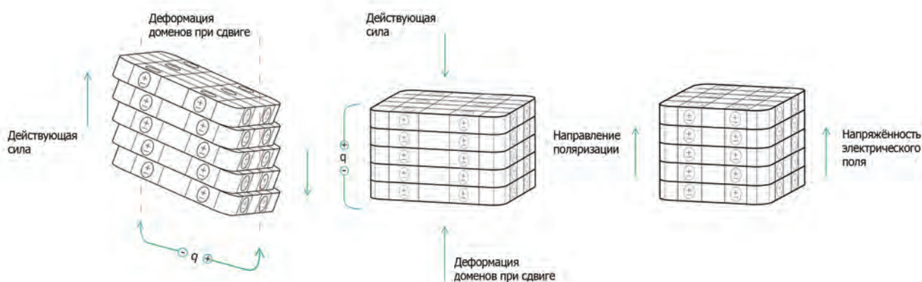
Упрощённая модель пьезоэлектрического эффекта искусственно поляризованной керамики. Электрический заряд q снимается с указанных поверхностей
