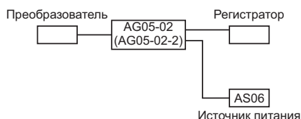
Схема подключения к регистрирующей аппаратуре
