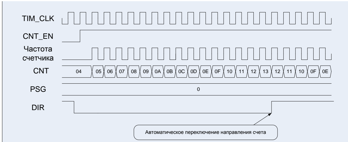
Рисунок 66. Диаграммы работы таймера, счет вверх/вниз, сначала вверх
