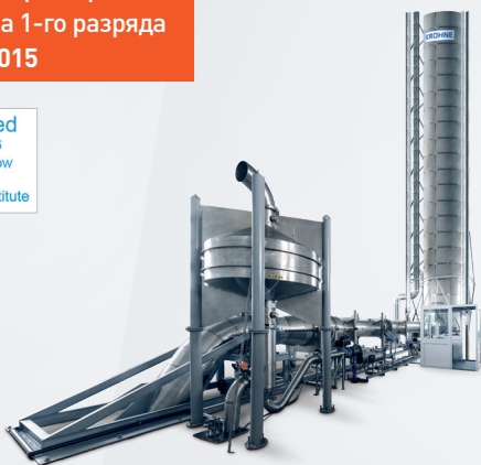
Установка эталонная REFERENCE TOWER PSTR 04
