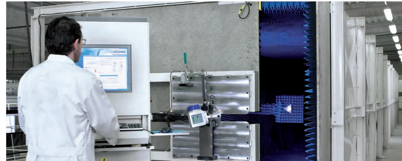
Участок калибровки радарных FMCW уровнемеров
