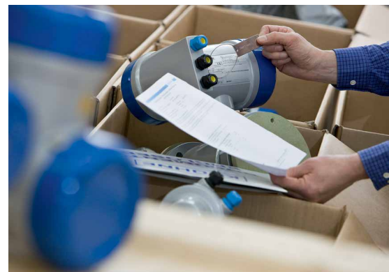
Ввод расходомеров в эксплуатацию
