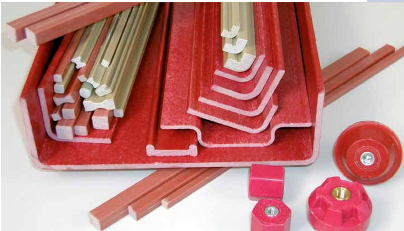
Стеклопластик профильный представляет собой полосы заданного профиля, изготовленные методом непрерывной протяжки через формующую фильеру стекложгутов, предварительно пропитанных связующим на основе эпоксидных смол.
