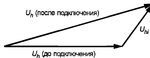
Рисунок 3 — Иллюстрация вектора эмиссии U_{hi} и его вклада в измеряемый вектор гармоники в точке оценки
