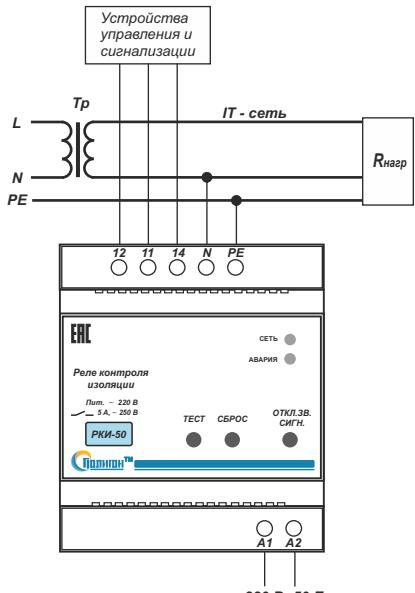
Типовая схема подключения блока РКИ-50 к однофазной сети.
