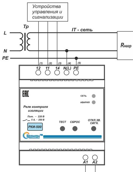
Типовая схема подключения блока РКИ-500 к однофазной сети.
