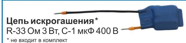
Для защиты линии от возникновения искры в однофазных и трехфазных сетях рекомендуется включать параллельно катушке пускателя искрогасящую цепочку R-33 Ом 3 Вт, С-1 мкФ 400 В.
