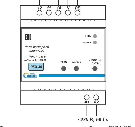
Типовая схема подключения блока РКИ-35 к однофазной сети.
