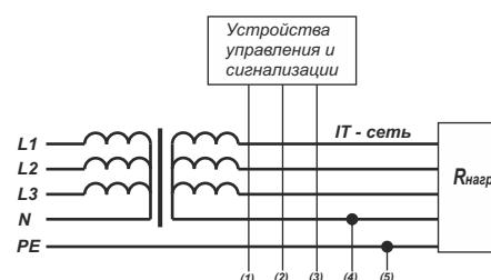
Типовая схема подключения блока РКИ-500 (24) к трехфазной сети с нейтралью.
