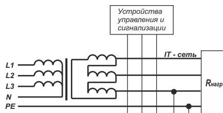
Типовая схема подключения блока РКИ-500 к трехфазной сети без нейтрали.
