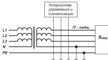
Типовая схема подключения блока РКИ-35 к трехфазной сети с нейтралью.
