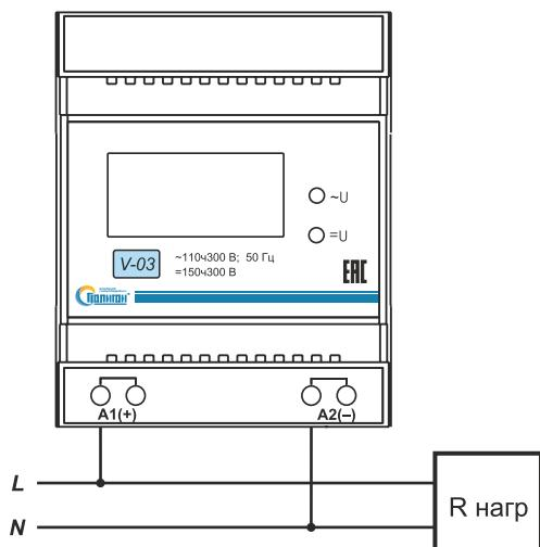
Схема подключения вольтметра V-03 (DC).
