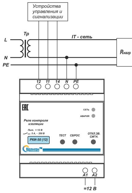
Типовая схема подключения блока РКИ-50 (12) к однофазной сети.
