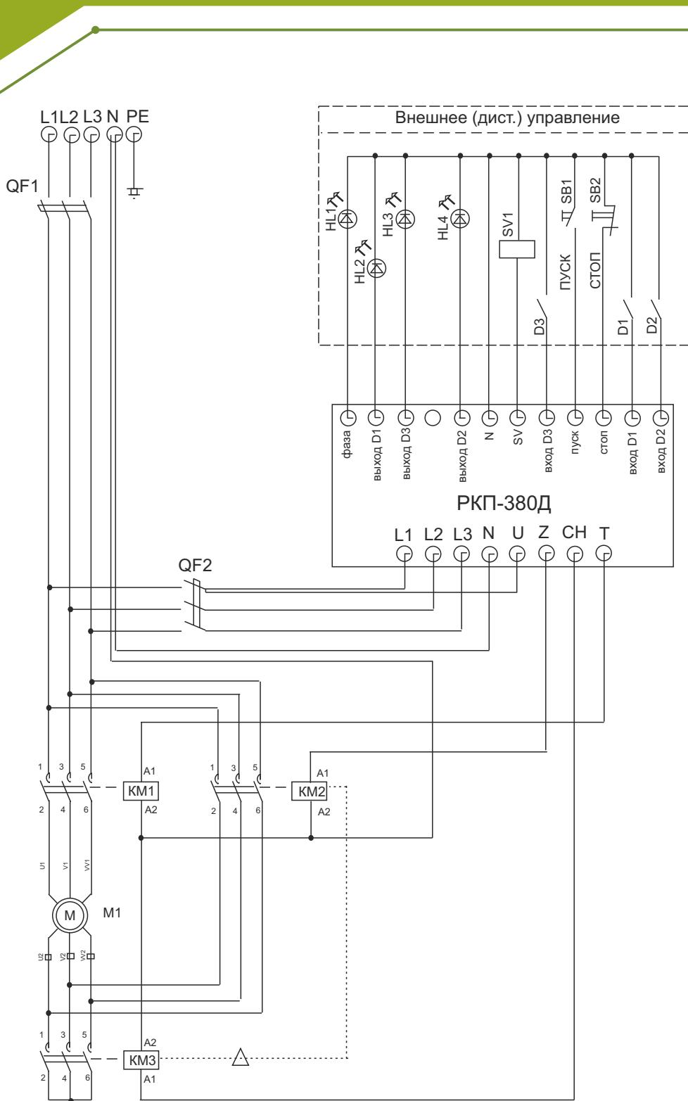
Типовая схема подключения реле РКП-380Д для управления пуском электродвигателя по схеме «звезда-треугольник».
