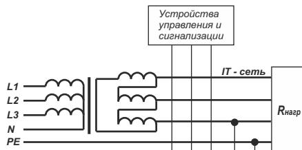
Типовая схема подключения блока РКИ-50 к трехфазной сети без нейтрали.
