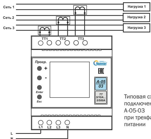
Типовая схема подключения А-05-03 при трехфазном питании
