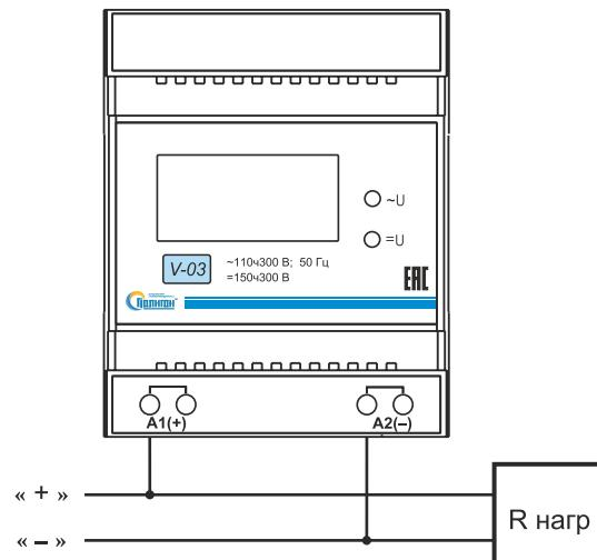
Схема подключения вольтметра V-03 (DC).
