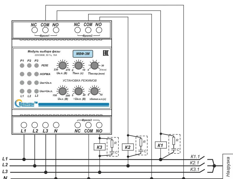
**Внимание!** Подключение цепей питания катушек контакторов и сигнальных цепей (L1, L2, L3, N) к силовой сети производить отдельными проводами.
