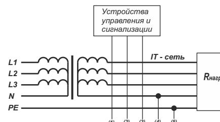
Типовая схема подключения блока РКИ-50 (12) к трехфазной сети с нейтралью.
