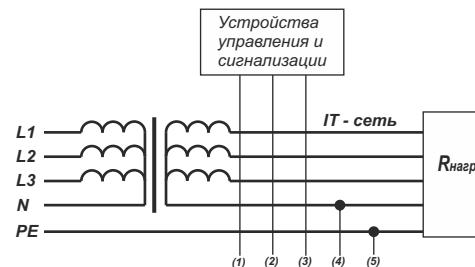
Типовая схема подключения блока РКИ-50(24) к трехфазной сети с нейтралью.
