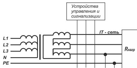
Типовая схема подключения блока РКИ-35 к трехфазной сети без нейтрали.
