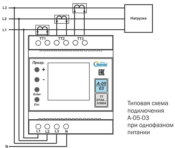
Типовая схема подключения А-05-03 при однофазном питании
