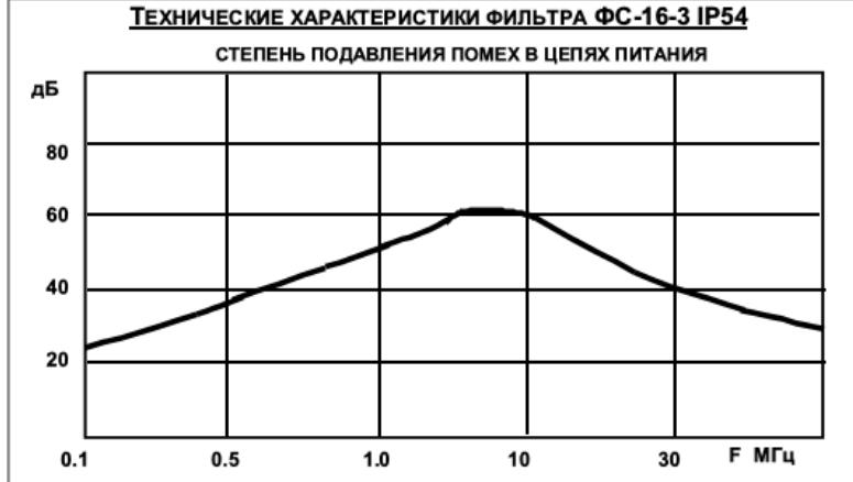
Рис.2. График АЧХ фильтра ФС-16-3 IP54 .
