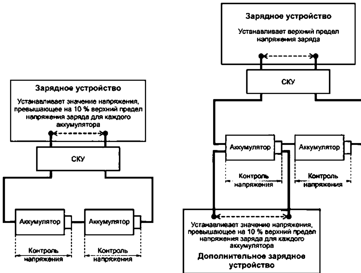
а) Избыточное напряжение прикладывается всей батарейной системе
