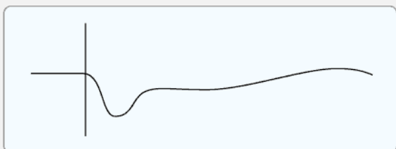
Вода в кабеле
