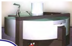
Вторичный эталон единицы ускорения с реализацией разгонного режима
