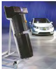
T-образная батарея может весить до 190 кг
