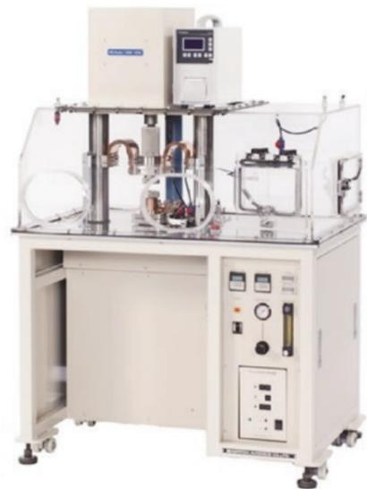
Полуавтоматическая установка герметизации корпусов с однофазным источником тока (метод рельефной сварки)
