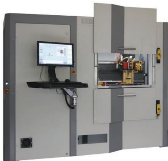
Автоматическая установка монтажа кристаллов на синтер-пасты и селективной лазерной пайки
