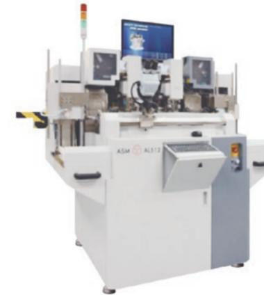
Автоматическая двухголовочная установка разварки кристаллов толстой проволокой (алюминий)
