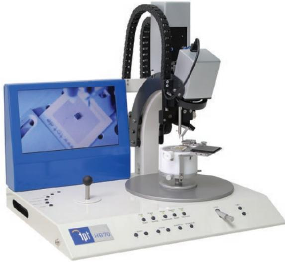
Ручная установка монтажа кристаллов
