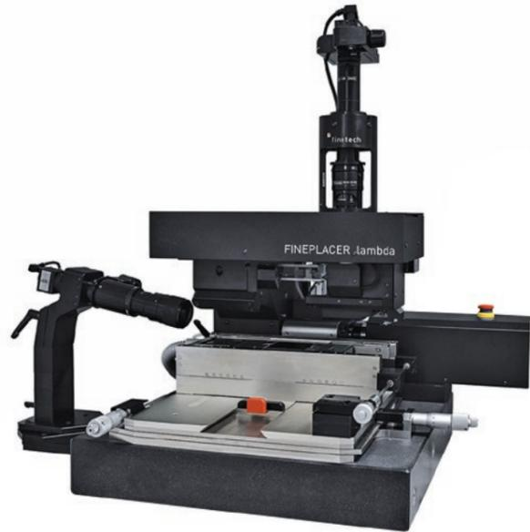
Субмикронная установка монтажа кристаллов и компонентов
