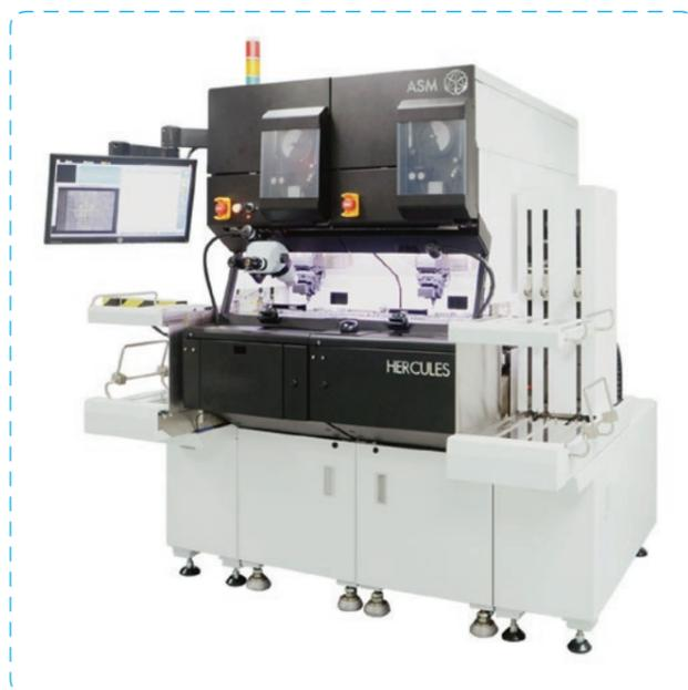
Автоматическая двухголовочная установка разварки кристаллов толстой проволокой (алюминий)
