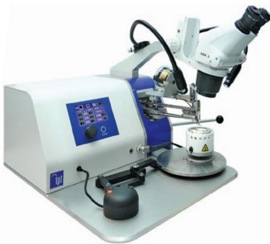
Универсальная ручная установка для клиновой микросварки и термозвуковой сварки золотым шариком
