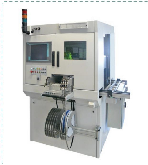
Автоматическая установка монтажа и селективной лазерной пайки кристаллов.
