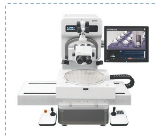
Прецизионная установка измерения прочности механических соединений бампов на пластине
