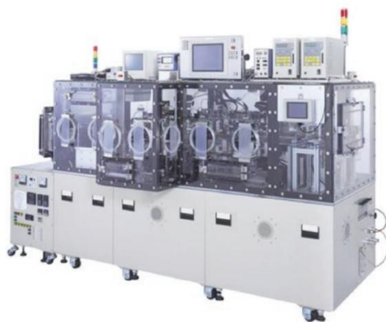
Автоматическая установка роликовой герметизации корпусов в среде азота
