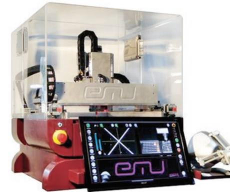
Автоматическая настольная установка монтажа полупроводниковых компонентов
