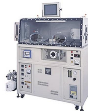
Полуавтоматическая установка роликовой герметизации корпусов в вакууме
