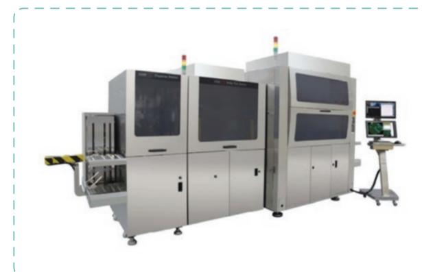
Автоматическая установка монтажа флип-чипов методом термокомпрессии
