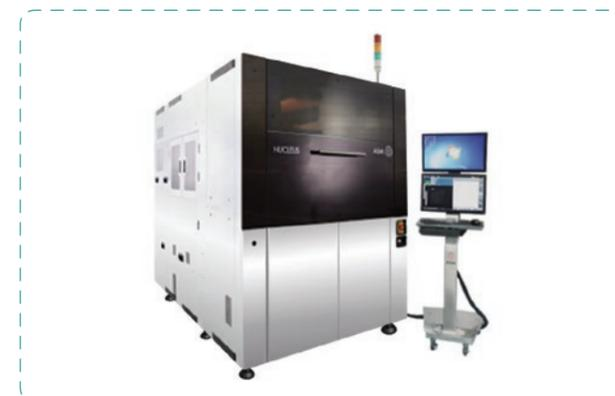
Многофункциональная высокоточная установка монтажа кристаллов
