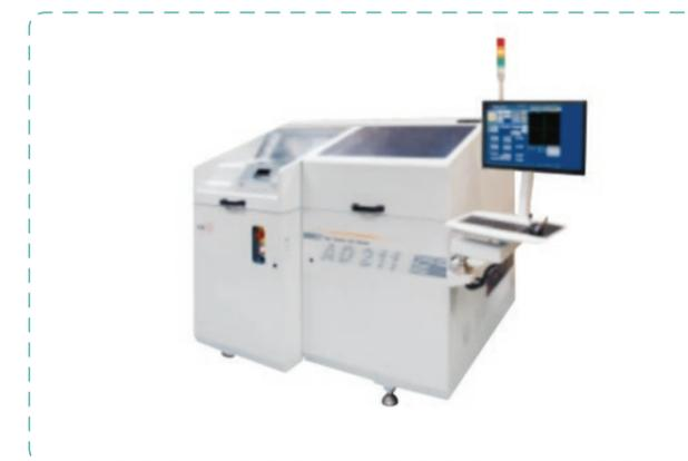
Автоматическая установка монтажа кристаллов методом эвтектической пайки
