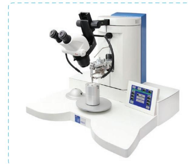
Ультразвуковая установка для микросварки толстой алюминиевой проволокой
