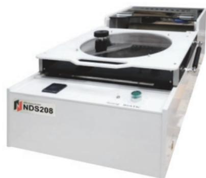
Установка монтажа пластин
