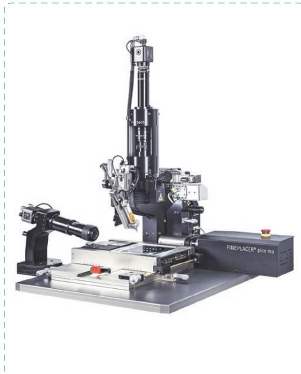
Универсальная установка монтажа кристаллов и компонентов
