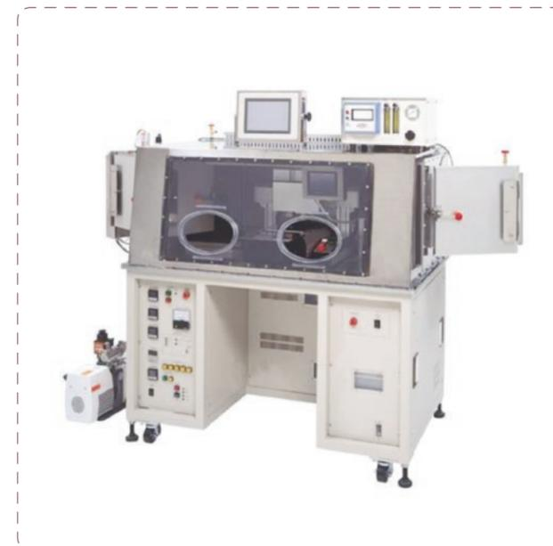
Полуавтоматическая установка роликовой герметизации корпусов в среде азота
