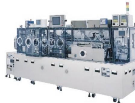
Автоматическая установка роликовой герметизации корпусов в вакууме
