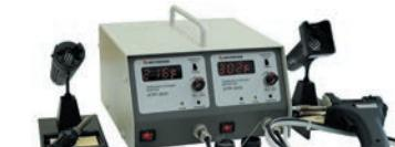
В паяльных станциях АКТАКОМ применена как аналоговая регулировка температуры, при которой требуемое значение температуры выставляется потенциометром по шкале, нанесенной на переднюю панель, так и микропроцессором, где температура устанавливается с помощью клавиатуры, а ее значение индицируется на цифровом табло.
