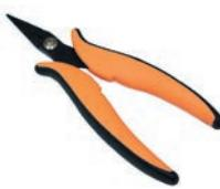
Многофункциональные плоскогубцы из закаленной углеродистой стали повышенной прочности с антикоррозионным покрытием и прямыми заострёнными узкими скруглёнными концами. Удобные обрезиненные рукоятки с возвратной пружиной. Насечки на концах для надёжного захвата. Длина 6 дюймов.
