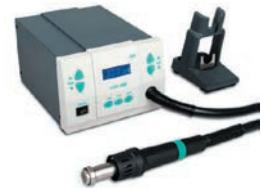
Такая конструкция сопел позволяет создать направленный поток горячего воздуха, который воздействует практически только на места пайки микросхем.
