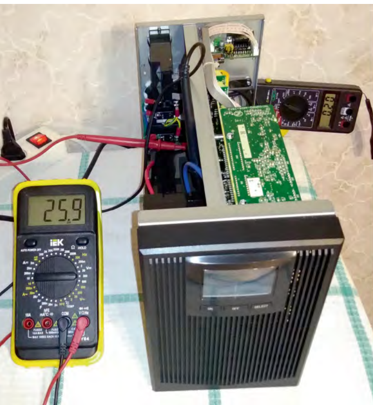
Измерение входного тока и напряжения АКБ
