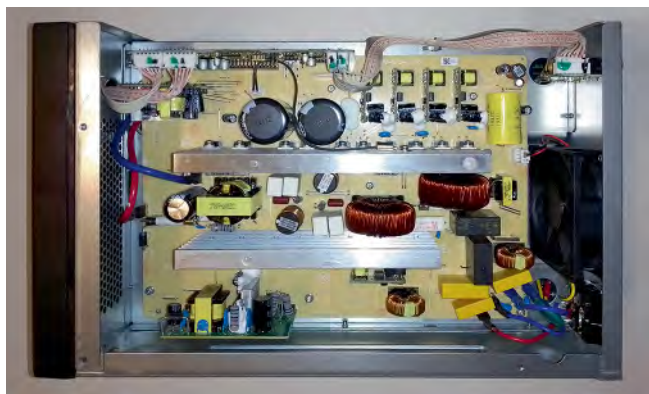
Внутреннее устройство ИБП Kehua Tech KR11 1kVA
