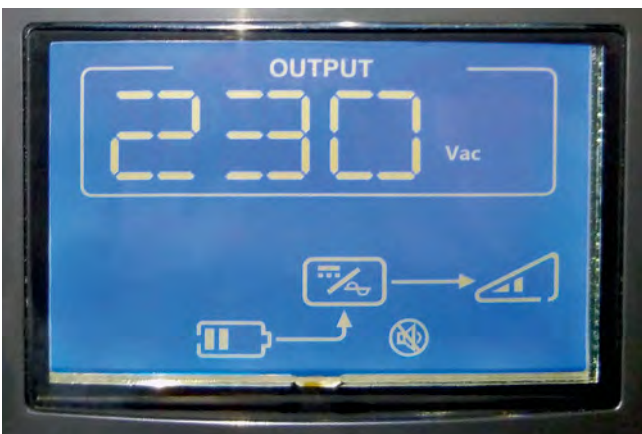
Работа ИБП в автономном режиме
