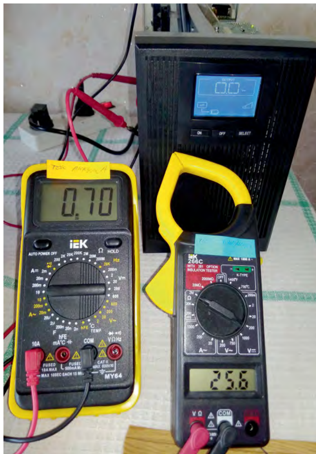
Процесс измерения параметров заряда: слева — ток, справа — напряжение батареи
