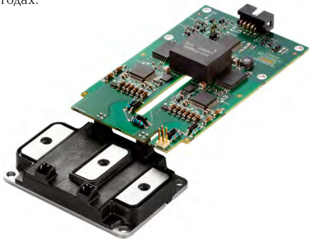
Недостатком большинства SiC-транзисторов является сложность конструкции драйвера для их управления
