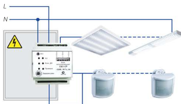
Схема подключения проводной системы управления освещением с применением силового блока СБЗ-С-ВР
