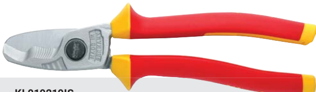
KL010210IS Кабелерез с изолированными рукоятками для NYM кабеля максимальным диаметром 25 мм
