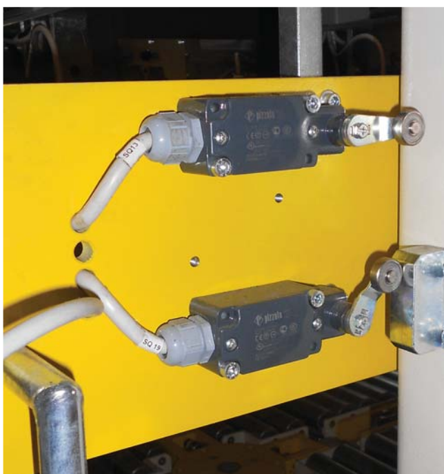
Пример работы концевых выключателей — нижний датчик активирован
