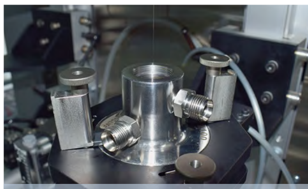
На линии буферных покрытий OG-510 на хрупкое оптоволокну наносят несколько полимерных слоев, чтобы дополнительно защитить его от воздействия влаги, обеспечить технологичность дальнейшей переработки и безотказной работы в заданном температурном диапазоне
