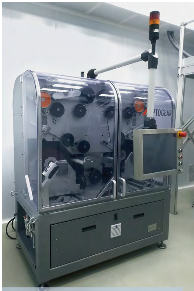
Сначала оптоволокну проходит «proof-test» на механическую прочность, что особенно актуально для волоконно-оптических кабелей, работающих в жестких условиях эксплуатации
