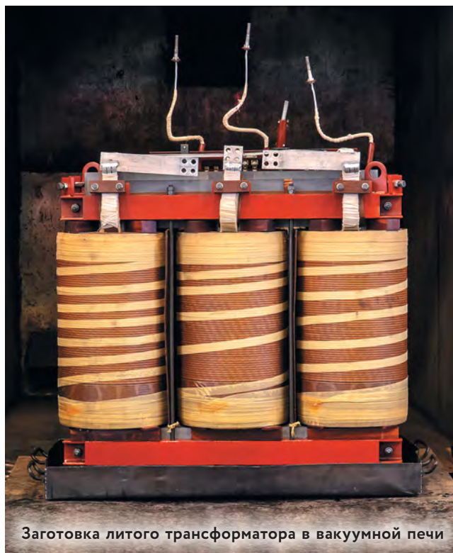
Сухой трансформатор с воздушно-барьерной изоляцией
