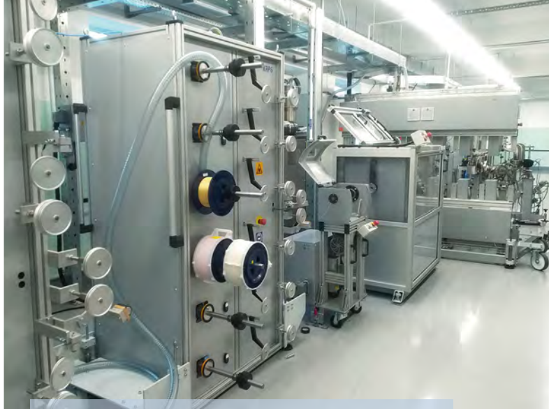
Экструзионная линия RL-P изготавливалась по техническому заданию «Спецкабеля»
