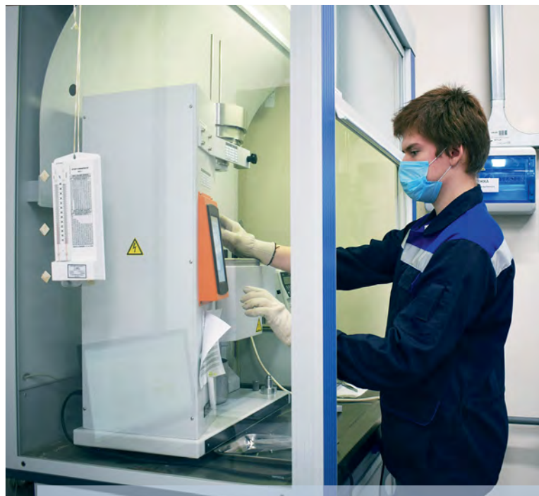
Экструзионный пластометр позволяет оценить технологические свойства материала
