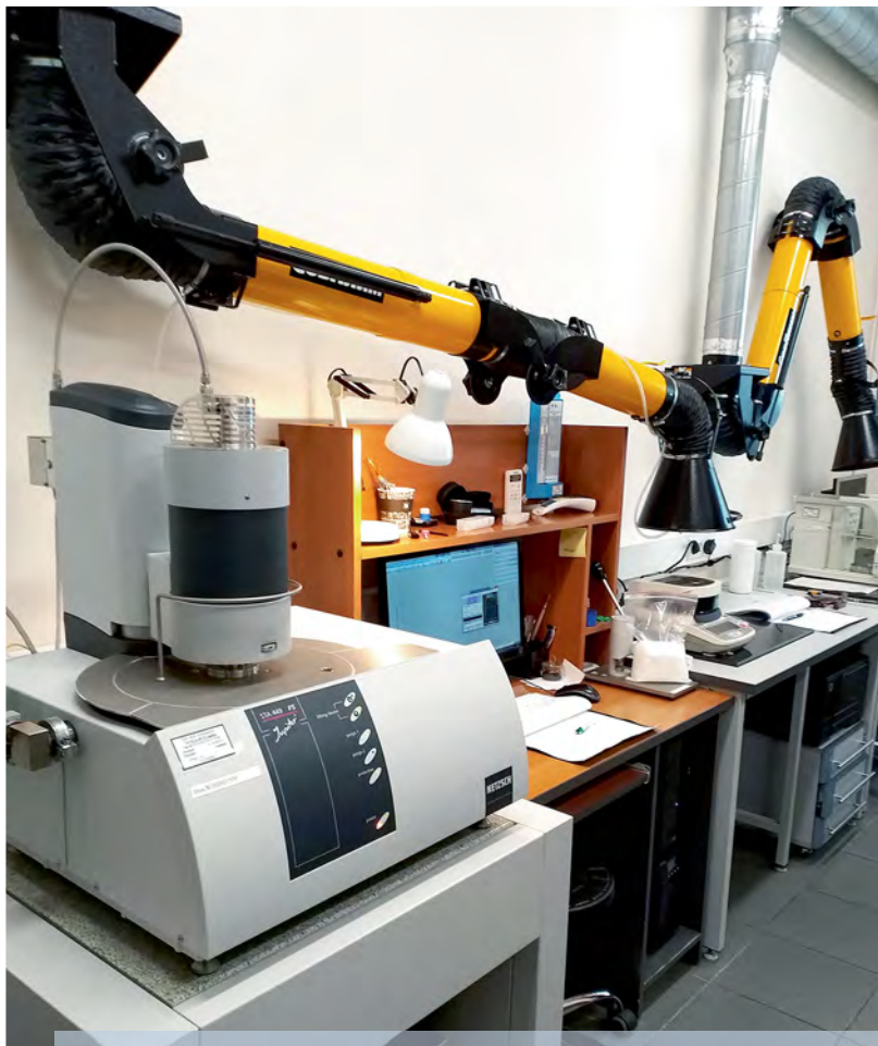
В компьютеризированной установке для синхронного термоанализа идут измерения показателей полимеров
