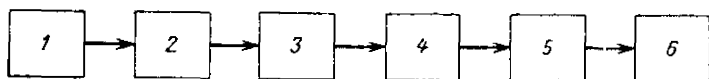
Рис. 3.41. Блок-схема измерения добротности методом передачи 1 — генератор СВЧ; 2 — аттенюатор; 3 — исследуемый резонатор; 4 — аттенюатор; 5 — детектор; 6 — индикатор.
