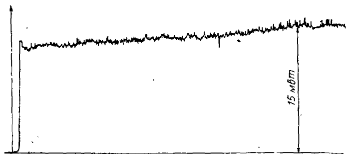
Рис. 1.12. Диаграмма записи уровня мощности. Время записи 49 мин.
