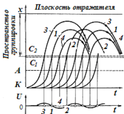
Рис. 8.7. Пространственно-временная диаграмма преобразования модуляции по скорости в модуляцию по плотности методом тормозящего поля
