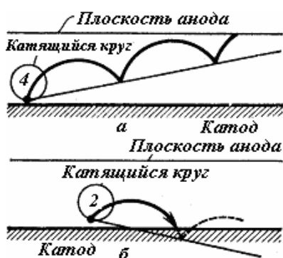
Рис. 12.12. Траектории движения «благоприятного» (4) и «неблагоприятного» (2) электронов в пространстве взаимодействия
