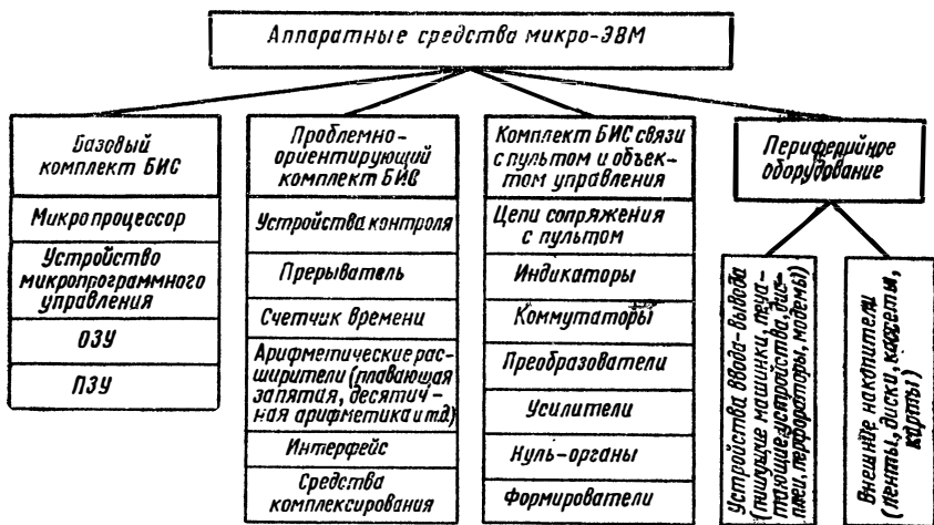
Рис 4.9. Состав аппаратных средств микро-ЭВМ.
