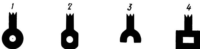
Рис. 13. Формы контактных площадок монтажных плат печатного типа:
