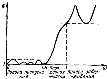
Рис. 1.3. Полоса пропускания, переходная область и полоса задерживания фильтра
