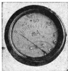
Рис. 24. Тепловой миллиамперметр типа ТИР, шкала 0—80 ма, предназначенный для включения в цепь антенны маломощного радиопередатчика
