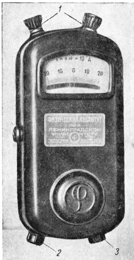
Рис. 27. Стрелочный МЭ гальванометр производства ФИЛУ, тип Н, шкала зеркальная, двусторонняя, с 20 делениями в каждую сторону от нуля посередине
