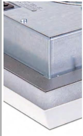
Mit einem Dachlüfter wird die warme Luft aus dem oberen Schaltschrankbereich abgesaugt. Als Lufteintritt sollte ein Filter GV 400/500 oder GV 600/700 mit Filtermatte im unteren Bereich des Schaltschranks eingebaut werden. Die Dachentlüftung DE 400 ohne Lüfter ist generell mit Filtermatte ausgerüstet, um das Eindringen von Staub zu verhindern. Die Dachentlüftung kann auch in Kombination mit Filterlüfter verwendet werden.
