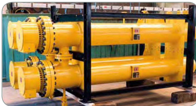
Проточный нагреватель мазута 1340кВт
