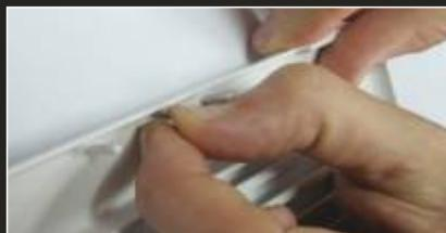
Usuń 3 wypustki umiejscowione z tyłu kratki
