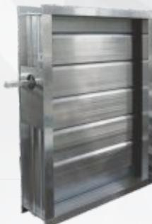
Przepustnice odcinają dopływ powietrza w przypadku gdy centrala jest wyłączona, dając przepływ przy rozruchu centrali. Przepustnice w ukladach z odzyskiem, z recyrkulacją pełnią funkcję regulacyjną oraz zabezpieczają wymiennik krzyżowy przed oblodzeniem. Stopień otwarcia może być ustawiany ręcznie lub przy pomocy silownika. Przepustnice wykonane są z profili aluminiowych. Szczelność przepustnic gwarantuje uszczelka montowana w każdym pionie elementu.
