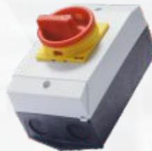
**Выключатель сервисный предназначен для выключения двигателя вентилятора с целью проведения сервисных или ремонтных работ. Применение выключателя предотвращает случайное включение двигателя вентилятора и травмы персонала. Есть возможность закрепления выключателя в положении 0, что обеспечивает состояние отключения, а повторное включение невозможно.**
