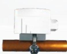
**PRZYGOWY CZUJNIK TEMPERATURY** - Uniwersalne, przylgowe czujniki temperatury z rezystancyjnym elementem pomiarowym PT1000. Czujniki temperatury dedykowane do pomiaru temperatury rurociągów, rur. Mocowanie czujnika opaską do powierzchni rury zapewnia jej sprężysty docisk sensora pomiarowego.
