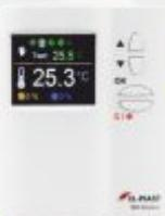
**Panel sterujący HMI Advance -** zadajnik z kolorowym wyświetlaczem. Umożliwia pełną konfigurację i odczyt parametrów pracy oraz stanów alarmowych sterownika PLC. Panel występuje również w wersji HMI Advance Multi 16, która umożliwia obsługę wielu układów jednocześnie przez połączenie magistralą RS485.
