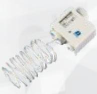
**Termostat przeciwzamorżeniowy (frost) -** stanowi powszechnie stosowane zabezpieczenie nagrzewnicy wodnej przed osiągnięciem zbyt niskich temperatur i uszkodzeniem. Sygnalizuje obniżenie temperatury za nagrzewnicą wodną poniżej krytycznej wartości, dając sygnał do załączenia procedur zabezpieczających.
