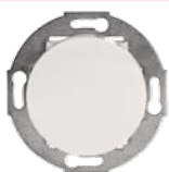
Переключатель перекрестный скрытой установки (Поставляется под заказ) Напряжение 250 В Ток 16 А Габариты R70 x 35 мм
