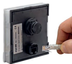
RJ45 для подключения к ATyS p M
