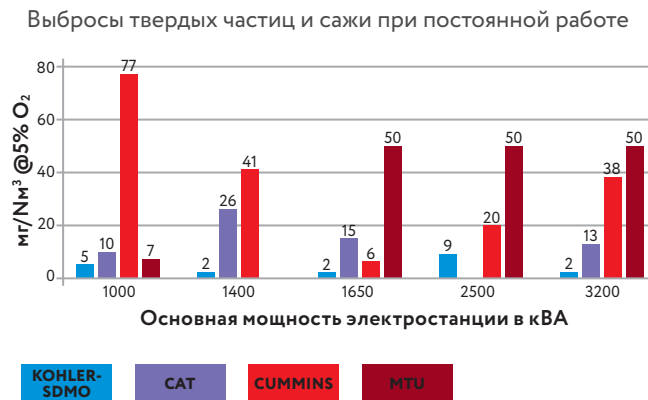
ГРАФИК 3. Сравнение эмиссии отработанных газов для разных производителей двигателей
