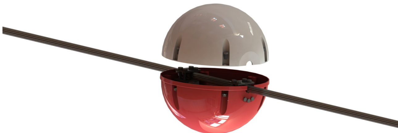
Рис.4. Схема сборки полусфер
