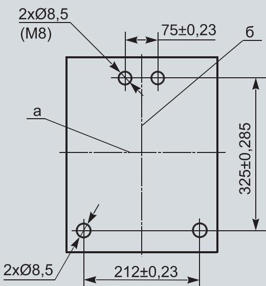
а) горизонтальная ось выключателя; б) вертикальная ось выключателя
