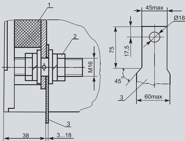
Допускается установка кабельных наконечников по ГОСТ 7386-80 с диаметром отверстия под жилу от 17 до 23 мм.
