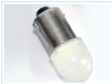
Источники света полупроводниковые ИП белого цвета свечения в металлопластмассовом исполнении со штифтовым цоколем типа В9s/14, предназначенные для применения в светотехническом оборудовании автотранспортной техники военного и гражданского назначения, для замены ламп накаливания МН26-0,12; СМ28-2,8; СМ28-4,8 применяемых в качестве подсветки и индикации бортовой аппаратуры.
