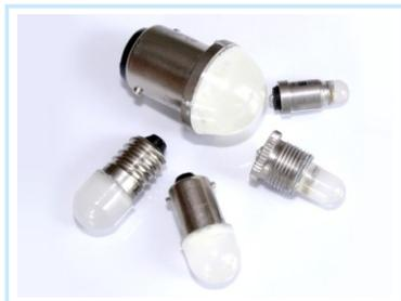
Серия источников света полупроводниковых желтого и белого цвета свечения предназначена для применения в светотехническом оборудовании наземной, авиационной и морской техники для освещения и подсветки шкал радио- и электроприборов, сигнализации, световой индикации и т. д. Конструктивное исполнение — металлопластмассовый корпус с цилиндрическим корпусом S6s/10, штифтовыми цоколями B9s/14, B15d/18, резьбовым цоколем E10/13 и специальным цоколем 1-M10-1.
