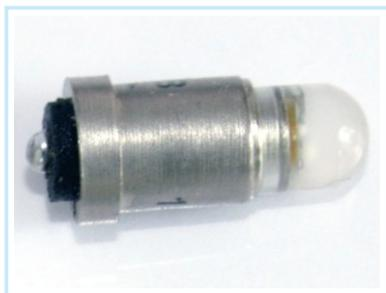
Источники света полупроводниковые ИП жёлтого и белого цвета свечения в металлопластмассовом исполнении с цилиндрическим цоколем типа S6s/10, предназначенные для применения в светотехническом оборудовании наземной, авиационной и морской техники военного назначения, для замены ламп накаливания CM 28-0,05 и CM 27-1,5 применяемых в качестве подсветки и индикации бортовой аппаратуры.
