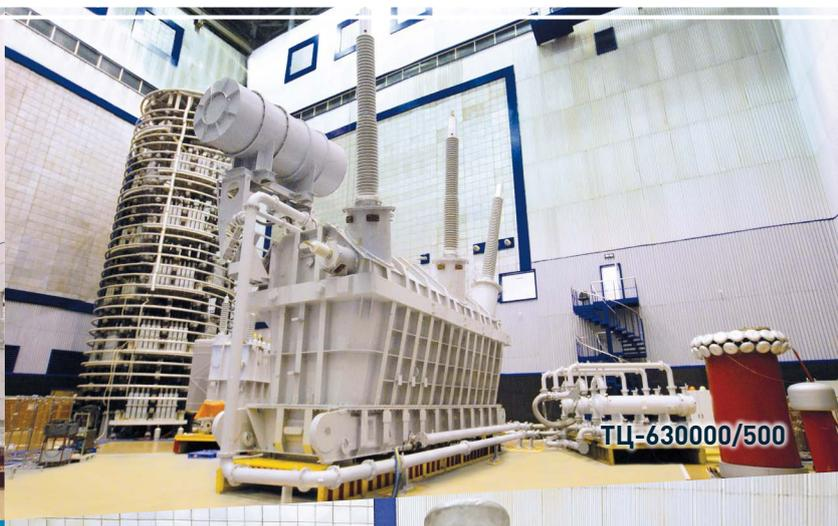
Силовые трехфазные двухобмоточные и однофазные двух- и трехобмоточные повышающие генераторные трансформаторы предназначены для работы в блоке с электрическими генераторами электростанций.
