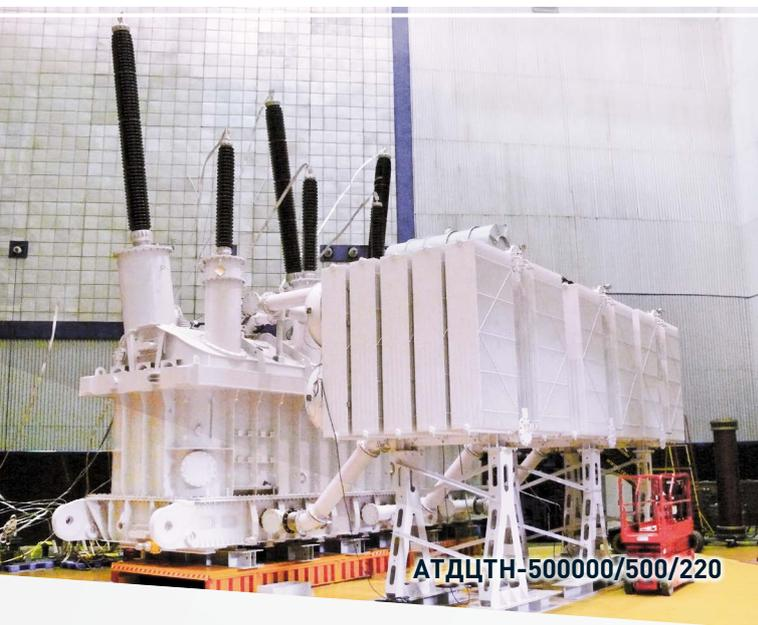
Силовые масляные трехобмоточные автотрансформаторы предназначены для связи электрических сетей напряжением 750, 500, 330, 220 и 110 кВ с одновременной подачей электропитания отходящим распределительным электросетям 10 и 35 кВ.
